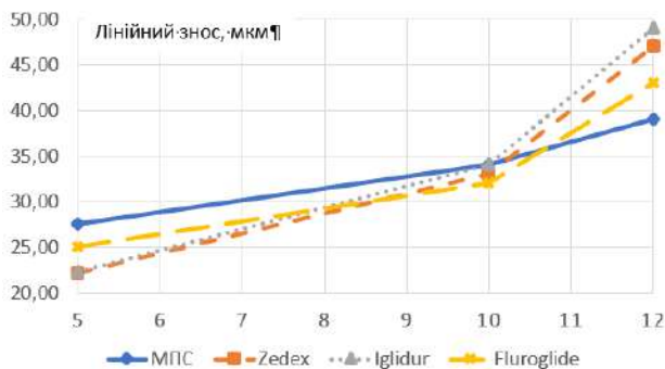
Рис. 2. Залежність лінійного зносу полімерних композиційних матеріалів від питомого навантаження в умовах вібрацій.
