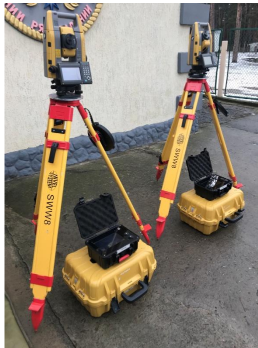
Рис. 2.9. Роботизований тахеометр TOPCON GT-502
