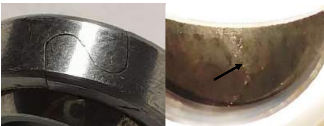
Рис. 5.7. Зони стику зовнішньої обійми шарнірного підшипника (а) та металополімерної стрічки (б)
