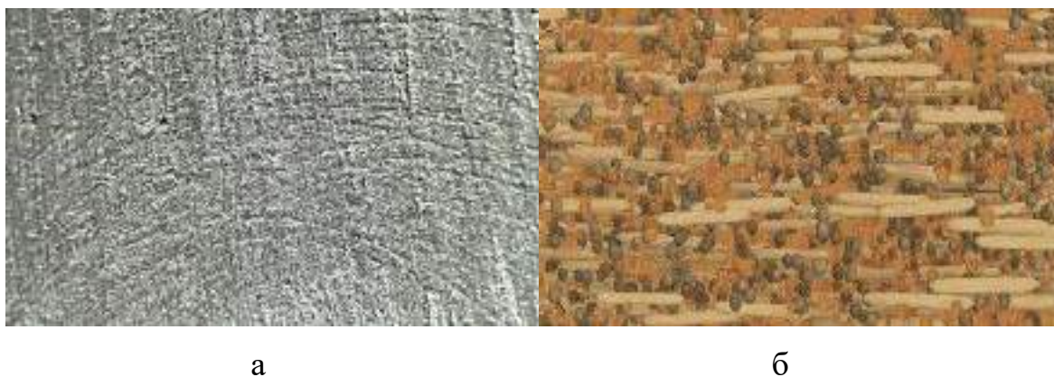
Рис. 4.2. Фотографія поверхні (а) та структура (б) матеріалів Zedex ZX-324VMT та Iglidur TX1.
