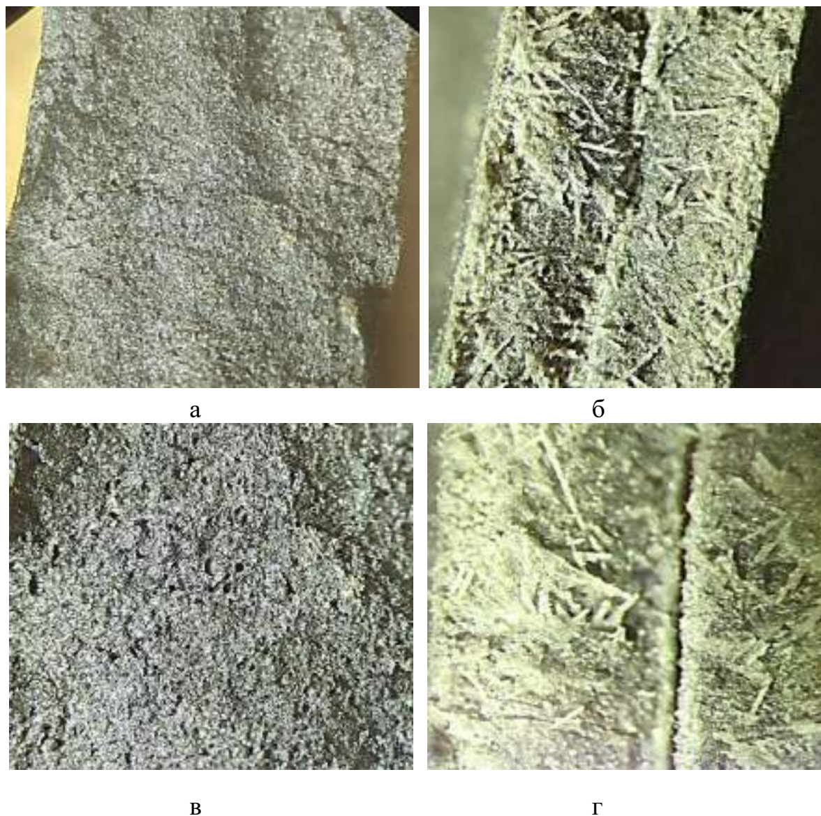
Рис. 5.2. Структури полімерних композиційних матеріалів ZX-324VMT (а, в) та TX1 (б, г) при збільшеннях в x28 (а, б) та x56 (в, г).
