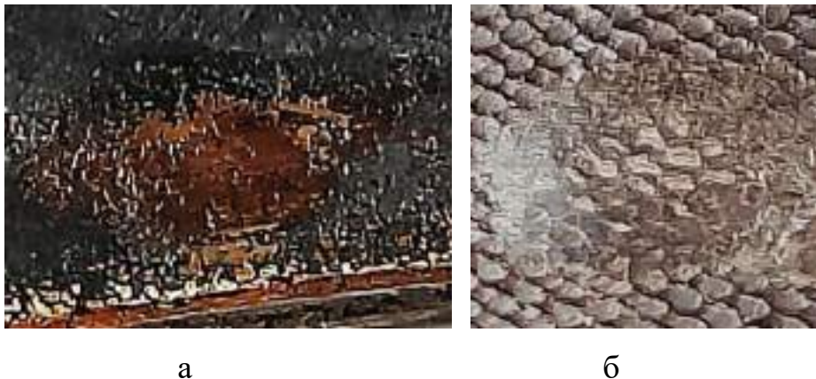
Рис. 3.6. Топографії пошкоджень поверхонь тертя металополімерної стрічки (а) та полімерного композиційного матеріалу Fluoroglide (б) після випробувань на зносостійкість. Умови випробувань ( V = 0,033 м/с, \nu = 3 Гц, P = 30 Н, N = 10^5 циклів).
