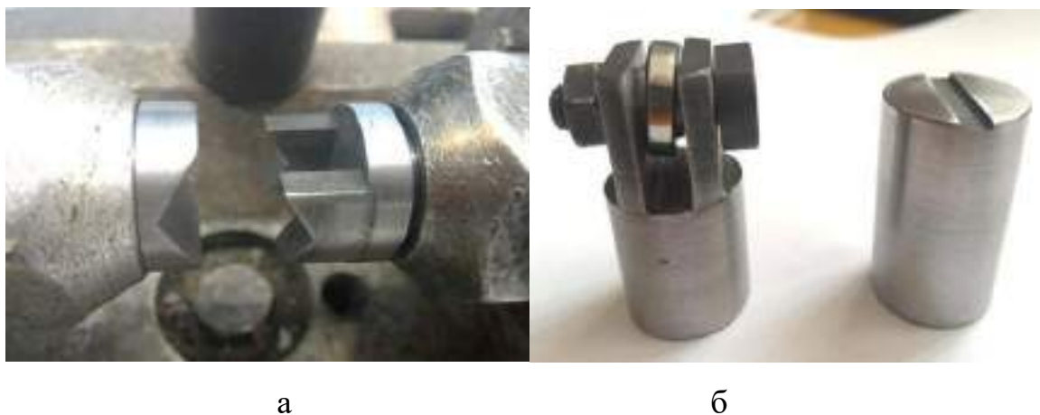
Рис. 2.6. Фото тримачів на установці (а) та їх зовнішній вигляд (б) для проведення випробувань шарнірних підшипників до 12 мм на модернізованій машині для дослідження процесів фретинг-корозії.
