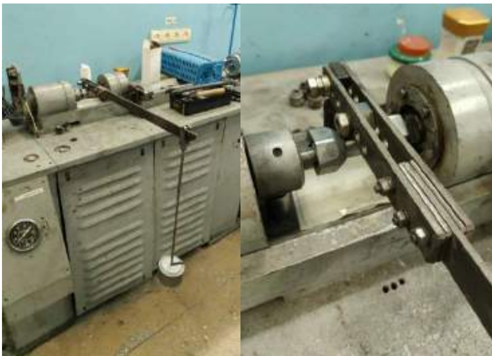
Рис. 2.11. Фотографії пристосування, що утримує та навантажує зразки при випробуваннях на реверсивне тертя.
